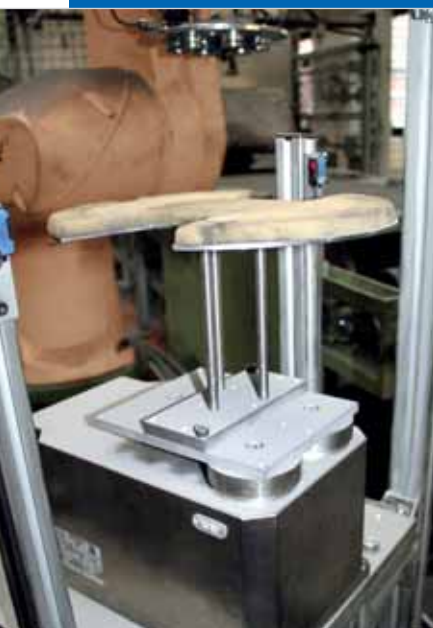
Roboterarm arbeitet mit Wäge kit Hand-in-Hand
