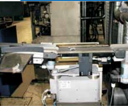
Wäge kit bei der Gewichtsermittlung des Sinterbauteiles
