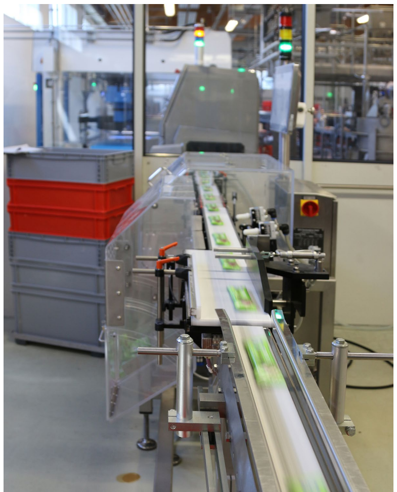
Barrette alla frutta: passano l'una dietro l'altra ad alta velocità nella pesatrice automatica doppia
