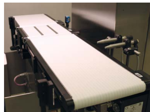
Rechazo mediante boquillas de aire comprimido
