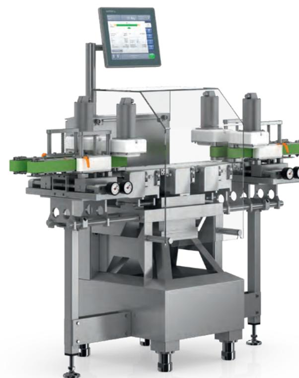
Cela permet de guider les produits en toute sécurité, notamment pendant les transferts entre les systèmes de convoyage. Les convoyeurs side-grip à compression latérale sont réglables en hauteur et en largeur de transport, ce qui permet de traiter une large gamme de produits et de formes diverses.
