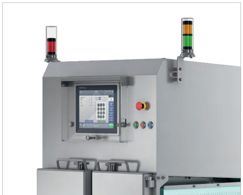
Abgedeckte Bedienoberfläche für höchste Hygieneanforderungen
