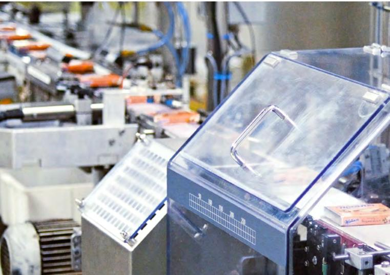
Kontrollwaage zur Qualitätsprüfung der Manner-Schnitten
