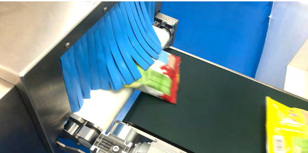
Strahlenschutz ist essenziell: Milchpulver „Rino“ am Auslaufvorhang der SC-E 4000
