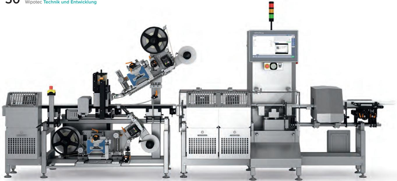
Etikettieren, Drucken, Optische Inspektion, Metalldetektion, Kontrollwiegen – alles in einer Steuerung
